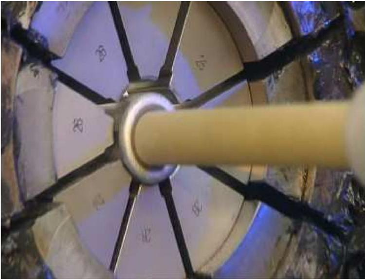
**Abb. 2.29** Details der Mehrkantpresse für die Armaturenverpressung
