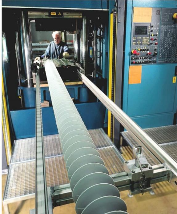
**Abb. 2.2** 6 m langer Verbundlangstab in der Fertigung
